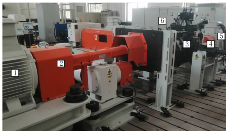
1—驱动电机;2—转速转矩仪;3—DHMT 传动系统; 4—测功机;5—加载电机;6—试验台架测控系统。
